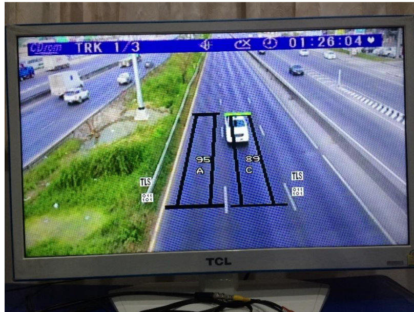
รูปที่ 4.3 วิธีการปรับแก้ความเร็วจาก Autoscope โดยวิธี Spot speed
