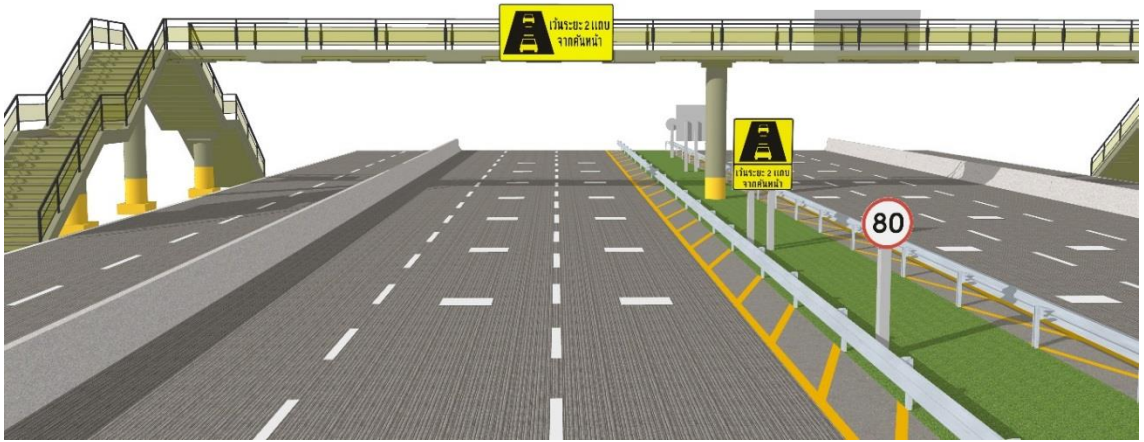
รูปที่ 4.33 ภาพจำลองการติดตั้งเครื่องหมายบนผิวจราจรแบบ “Transverse Bar” และป้ายเตือน
