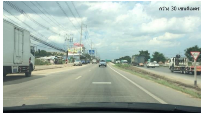
รูปที่ 4.21 การทดสอบติดตั้งเครื่องหมาย “Transverse Bar” ขนาด 1×0.3 เมตร
