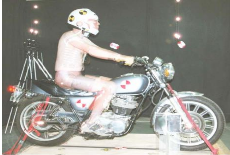
รูปที่ 3.11 หุ่นทดสอบการชนของรถมอเตอร์ไซด์ [46]
