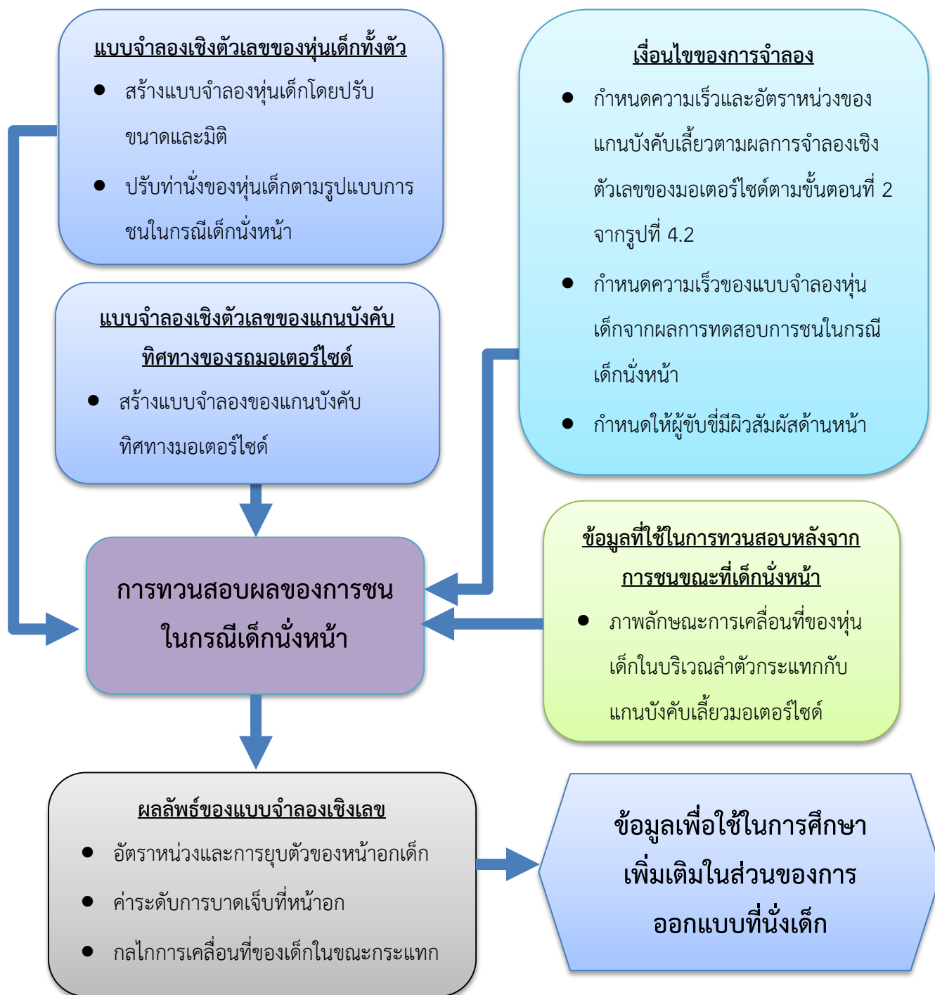
รูปที่ 4.3 แผนผังของการจำลองเชิงตัวเลขขั้นตอนที่ 3 กรณีหุ่นเด็กชนที่แกนบังคับเลี้ยวรถมอเตอร์ไซด์
