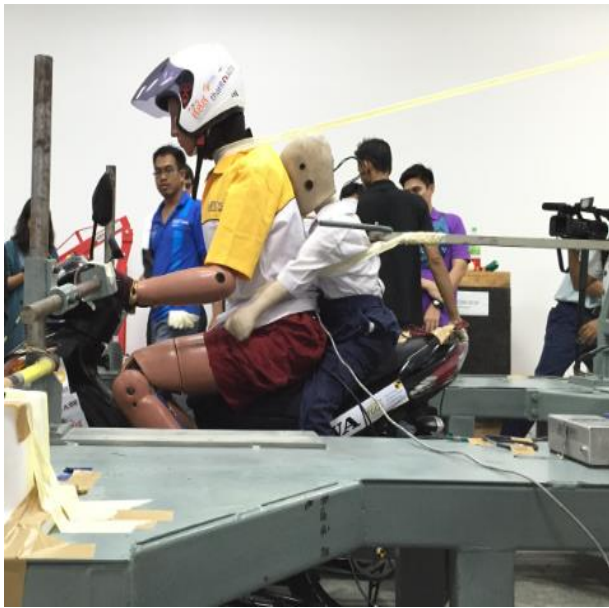
รูปที่ 3.20 การติดตั้งหุ่นที่ทำการทดสอบในขณะที่เด็กนั่งอยู่ทางด้านหลังผู้ขับขี่
