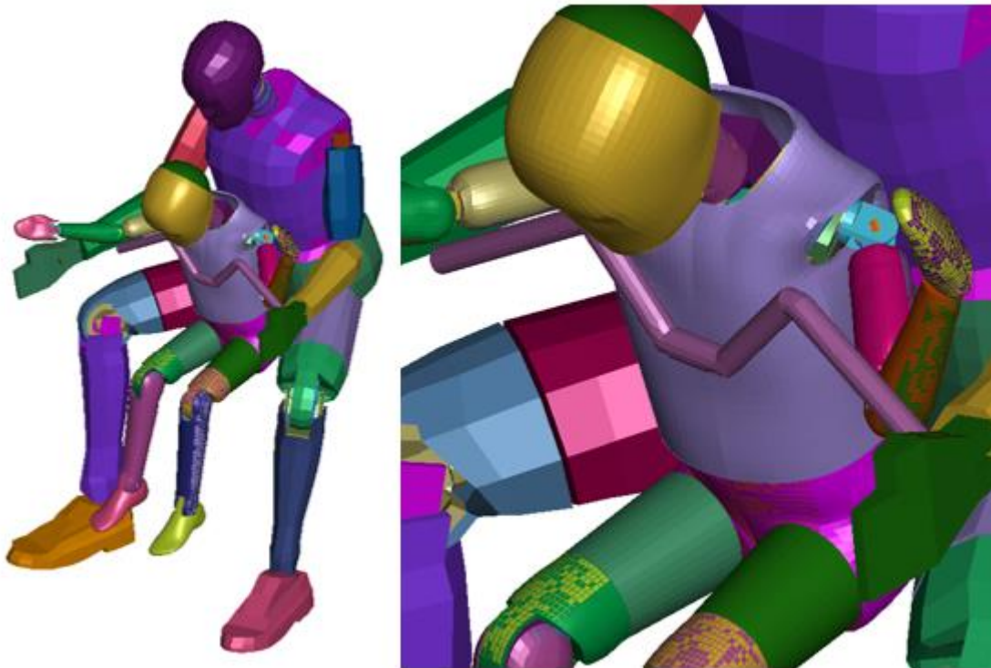
รูปที่ 4.27 จุดเริ่มต้นการกระแทกของแกนบังคับเลี้ยวของรถมอเตอร์ไซด์ในกรณีที่เด็กนั่งอยู่ที่ด้านหน้า
