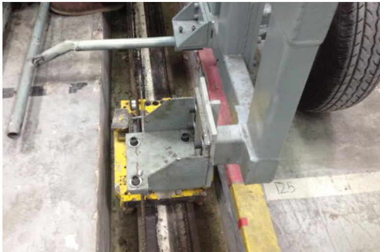
รูปที่ 3.16 โครงสร้างขับเคลื่อนมอเตอร์ไซด์ (บนซ้าย) ตำแหน่งที่ใช้ในการพลิกตัว (บนขวา) รอกวางเลื่อนรับแรงดึงมาจากต้นกำเนิดความเร็วที่เป็นเครื่องยนต์ผ่านลวดสลิง (ล่าง)
