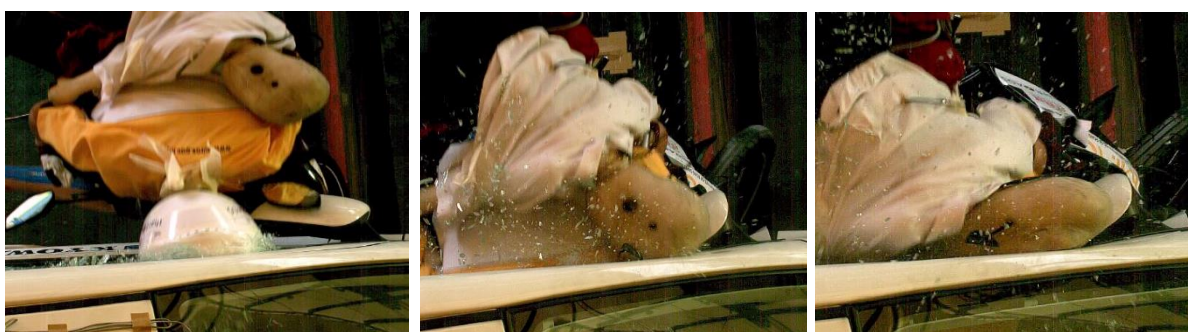
รูปที่ 3.24 ลำดับการเคลื่อนที่ของหุ่นเด็กในขณะกระแทกด้านข้างในกรณีที่ได้กนั่งโดยสารด้านหลังจากกล้อง ความเร็วสูงด้านบนของรถยนต์
