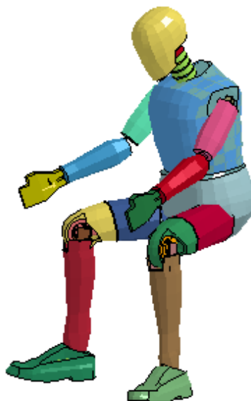
รูปที่ 4.13 การปรับเปลี่ยนท่าทางการยืนของหุ่นทดสอบการชนมาเป็นท่านั่งขับขึ้นขั้นตอนที่ 3
