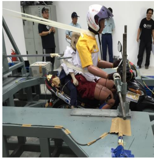
รูปที่ 3.20 การติดตั้งหุ่นที่ทำการทดสอบในขณะที่เด็กนั่งอยู่ทางด้านหลังผู้ขับขี่
