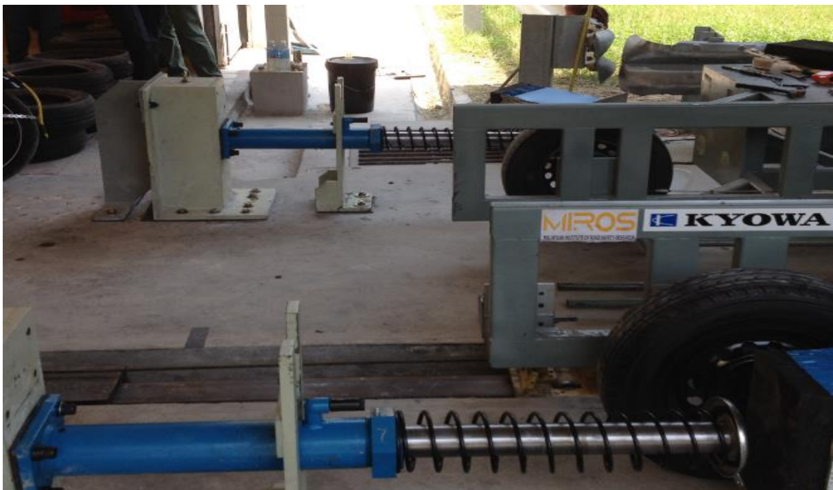
รูปที่ 3.19 อุปกรณ์รับแรงกระแทกของการเคลื่อนที่ของชุดขับเคลื่อนมอเตอร์ไซด์ (ชุดสีฟ้า)
