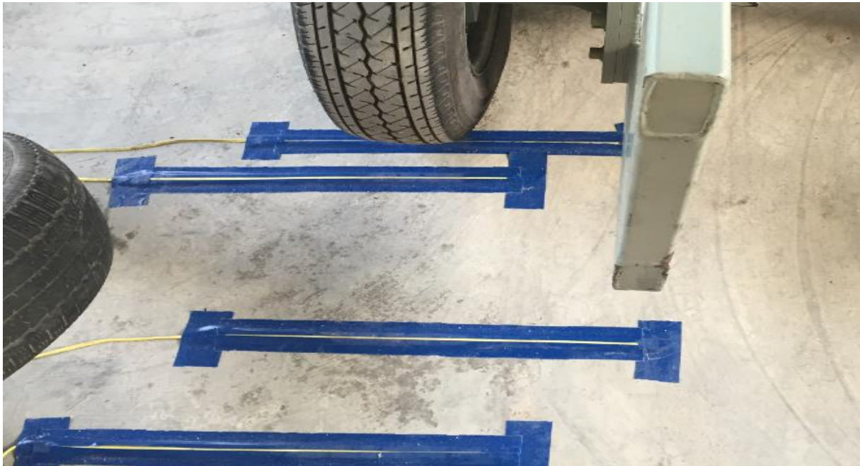
รูปที่ 3.9 การกระตุกตัวจับสัญญาณของเครื่องตรวจจับความเร็วก่อนชนโดยใช้ล้อของชุดขับเคลื่อนมอเตอร์ไซด์
