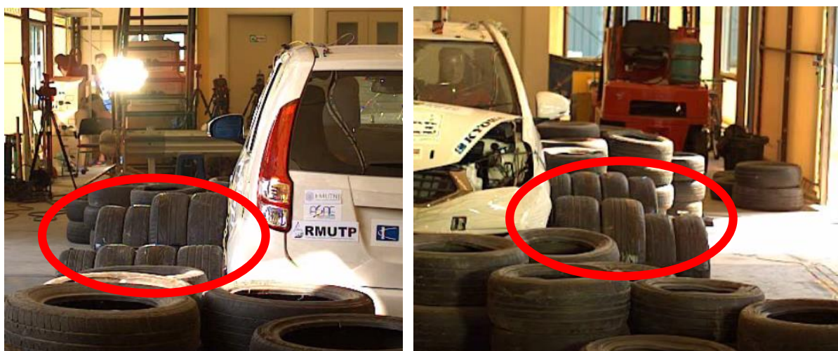
รูปที่ 3.27 การติดตั้งยางรถยนต์เพื่อเป็นวัสดุเสริมรับแรงกระแทกจากชุดขับเคลื่อนมอเตอร์ไฮดรอลิกครั้งที่ 2
