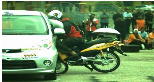
รูปที่ 1.3 การทดสอบการชนมอเตอร์ไซด์รุ่นเล็กแบบเต็มสเกล [14]
