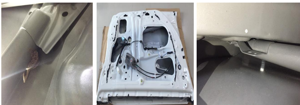
รูปที่ 4.5 ประตู่รถยนต์ก่อนที่นำมาใช้ในการทดสอบการชนของรถมอเตอร์ไซด์
