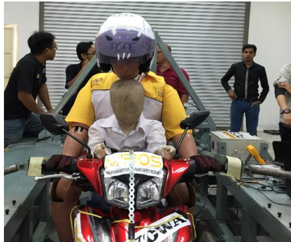
รูปที่ 3.21 การติดตั้งหุ่นที่ทำการทดสอบในขณะที่เด็กนั่งอยู่ทางด้านหน้า
