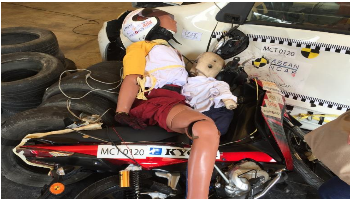
รูปที่ 3.32 ตำแหน่งสุดท้ายหลังจากการทดสอบในกรณีเด็กนั่งด้านหน้าของผู้ขับขี่
