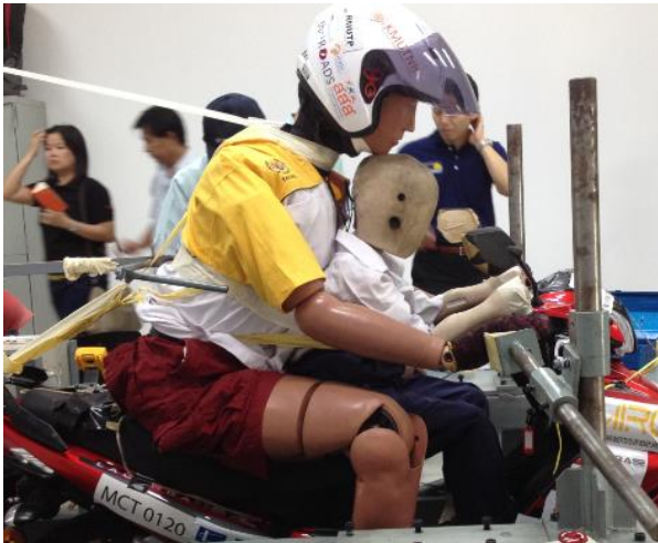
รูปที่ 3.21 การติดตั้งหุ่นที่ทำการทดสอบในขณะที่เด็กนั่งอยู่ทางด้านหน้า
