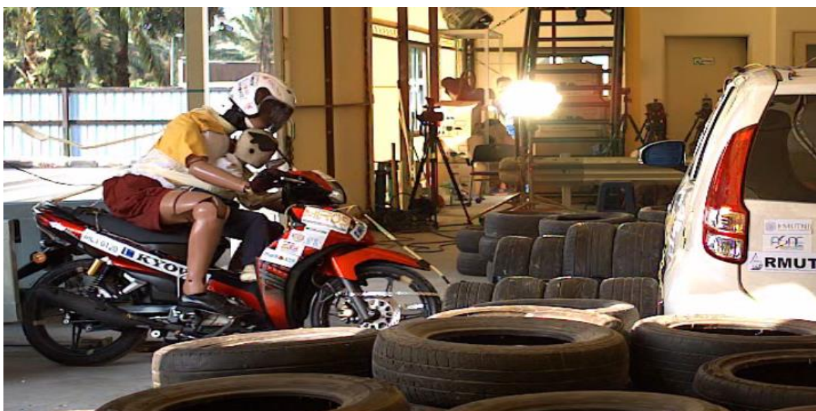
รูปที่ 3.28 การเคลื่อนที่อย่างอิสระของมอเตอร์ไซค์หลังซดซับเคลื่อนมอเตอร์ไซค์เริ่มหยุดการเคลื่อนที่
