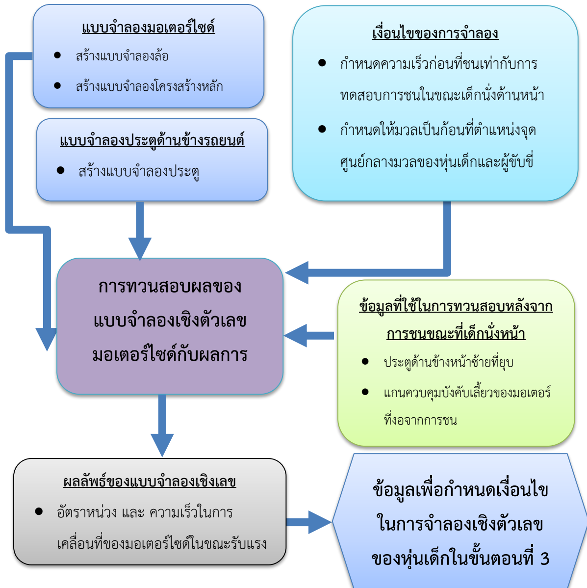
รูปที่ 4.2 แผนผังของการจำลองเชิงตัวเลขขั้นตอนที่ 2 กรณีตัวรถมอเตอร์ไซด์ชนกับด้านข้างของรถยนต์
