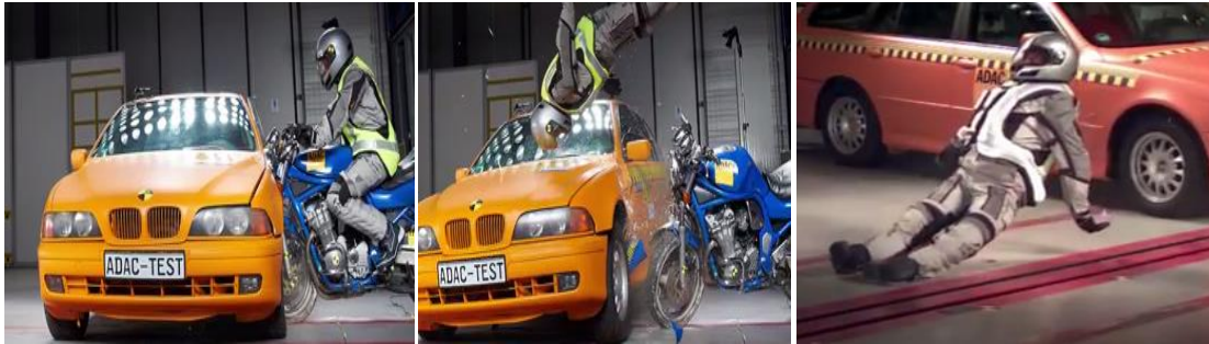
รูปที่ 3.2 ผลการทดสอบการชนของมอเตอร์ไซด์ที่ส่วนหน้าของรถยนต์ [34]
