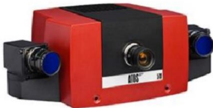
รูปที่ 4.6 เครื่องถ่ายภาพ 3 มิติยี่ห้อ ATOM Compact SCAN [52]
