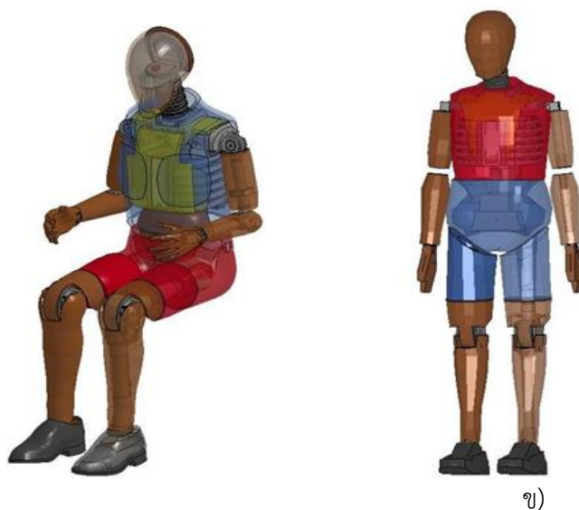
รูปที่ 4.12 ลักษณะท่ามาตรฐานของแบบจำลองหุ่น Hybrid III ก) หุ่นสำหรับคนขับในรถยนต์ ข) หุ่นสำหรับคนเดินถนนในทำนองยืนที่มีให้ในโปรแกรม LS DYNA
