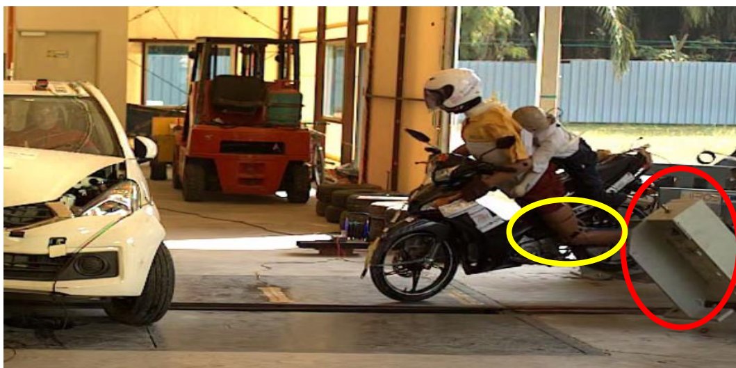
รูปที่ 3.22 ความเสียหายของชุดอุปกรณ์รับแรงกระแทก (สีแดง) และการรั้งที่ขาด้านขวาของหุ่นคนขับขี่ (สีเหลือง) ในกรณีที่เด็กผู้โดยสารนั่งหลังผู้ขับขี่
