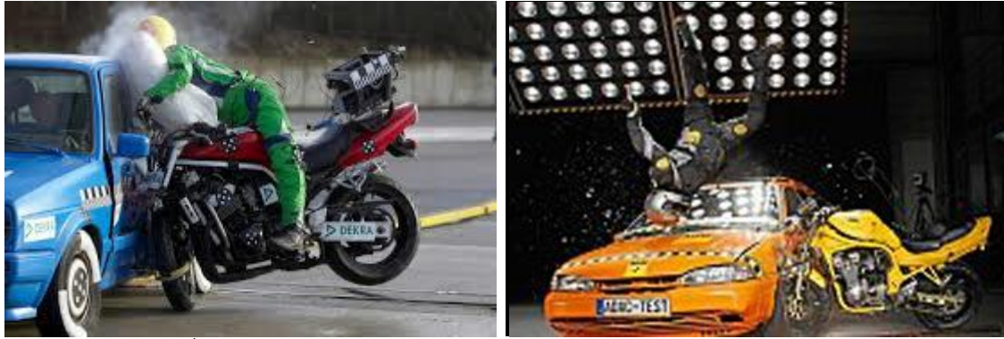
รูปที่ 1.2 การทดสอบการชนของรถมอเตอร์ไซด์รุ่นใหญ่แบบเต็มสเกล [12] [13]
